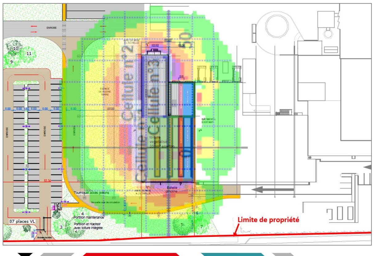
Figure 4 : Cartographie des effets thermique du scénario incendie sur plan de masse (Source : ELCIMAT)
